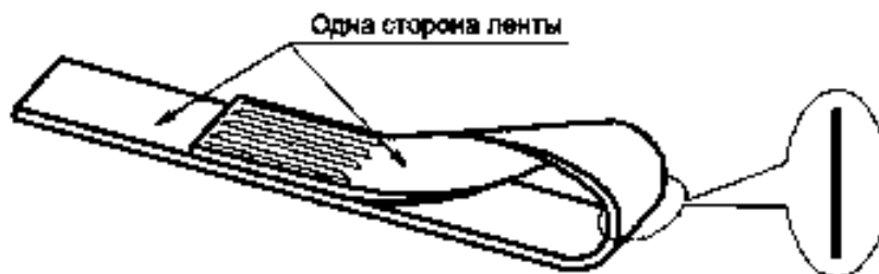
Рисунок 8 — Скрученная петля стропа
